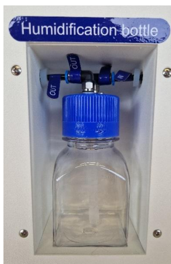
Figur 22.1 Slangetilslutning fra befugtningsflasken til Mini MIRI® Humidity multiroom IVF-inkubatoren
