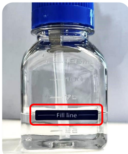
Figur 22.2 Fyldelinje på befugtningsflasken
